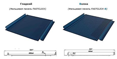
Характеристики: Полная ширина – 531 мм Полезная ширина – 485 мм Высота замка – 33 мм Диапазон длин – от 0,5м до 12м Толщина стали – 0,5 мм
